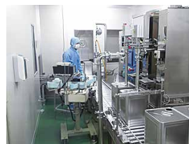
クリーン充填室（クラス 1,000）
