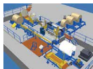
仕上設備 ロール包装機
