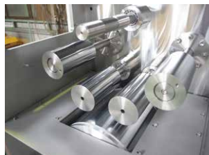
ロールコーター装置
