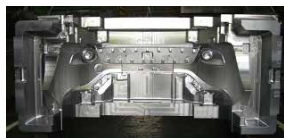
自動車 フロントバンパー 樹脂成型型 S45C
