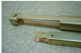
プレスによる角パイプの切り欠き
