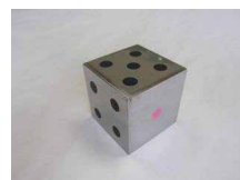
(サンプル 4) SUS304 板厚 1 ミリのサイコロ形状 中に水が入っています
