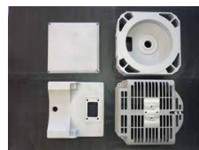
加工面を極限まで無くし パッキン溝、ボス、鋳肌面と 綺麗な製品を提供します
