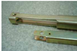
プレスによる角パイプの切り欠き
