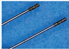
φ 0.3先端にダイヤを固着
